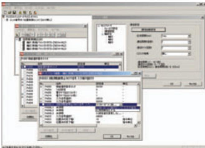
位置制御ユニットとサーボドライバをプロジェクトに追加。それぞれのパラメータを簡単に編集できます。また、位置制御ユニットのパラメータおよび接続されたサーボドライバのパラメータを転送できます。
