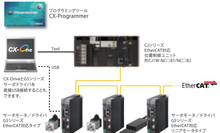
位置制御ユニットとG5シリーズのサーボをつなぐ超高速モーションネットワーク、EtherCAT。EtherCATなら、サーボ単体性能だけでなく、PLCからサーボまでのシステム全体の性能を向上します。
