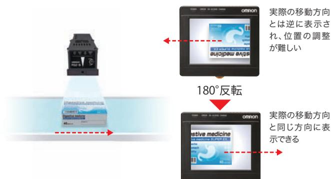
実際の移動方向とは逆に表示され、位置の調整が難しい
