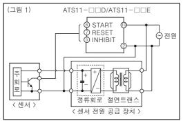
• (그림 2)와 같이 단자 ⑩을 입력 신호의 공통단자로 사용 하면 ATS11-□□D/ATS11-□□E 타이머의 내부회로 의 손상을 일으키므로 (그림 3)과 같이 ②단자를 공통단자 로 사용하여 주십시오.
